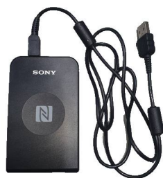
Fig.2.1: 非接触 IC カードリーダー/ライター RC-S380
